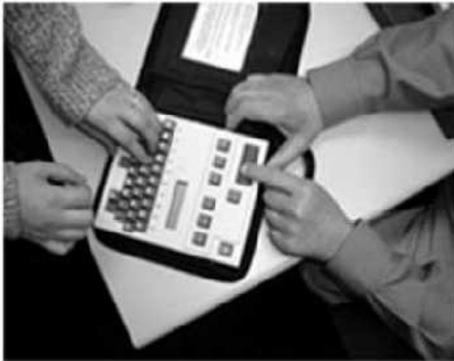
चित्र 4.67: दो लोग एक-दूसरे के साथ वार्तालाप हेतु स्क्रीन ब्रेल संचार का उपयोग करते हैं
